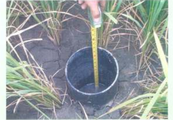
চিত্র ২: এ ডাব্লিউ ডি পদ্ধতিতে পানির অবস্থা পর্যবেক্ষণ করা হচ্ছে
